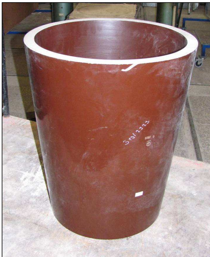
Foto 3: Pohled na zkoušený vzorek keramického elektrofiltru po provedení mechanické zkoušky v tlaku – vz. 1/14 (2323)
