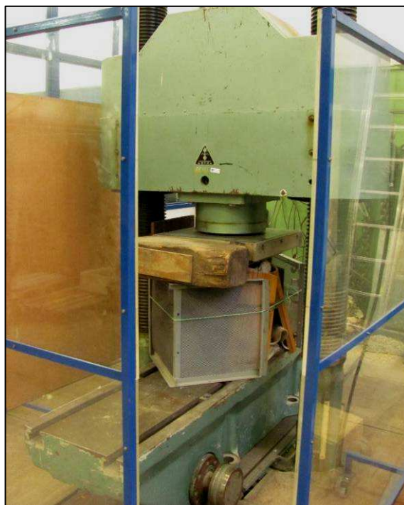
Foto 2: Pohled na uspořádání mechanické zkoušky v tlaku keramického elektrofiltru
