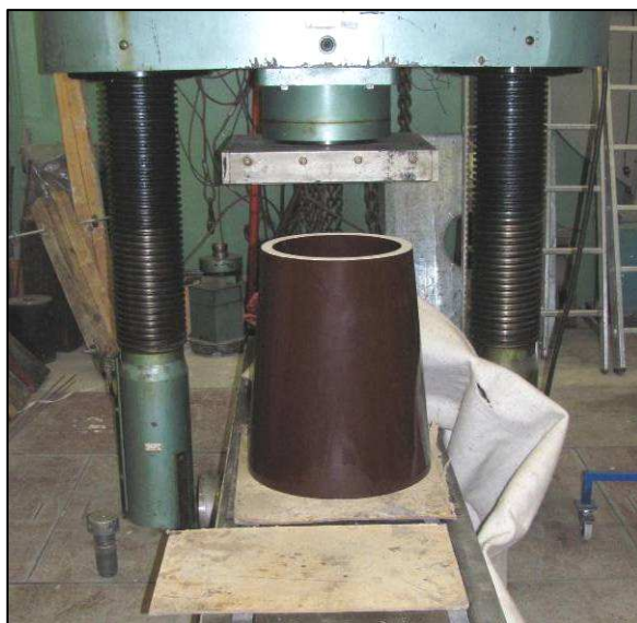
Foto 1: Pohled na vzorek keramického elektrofiltru umístěného do zkušebního stroje
